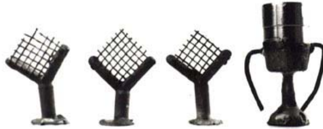
FIGURA 3 Coroa fundida no troquel de aço padrão de “A.D.A.”; Teste da minirrede (fundibilidade).
